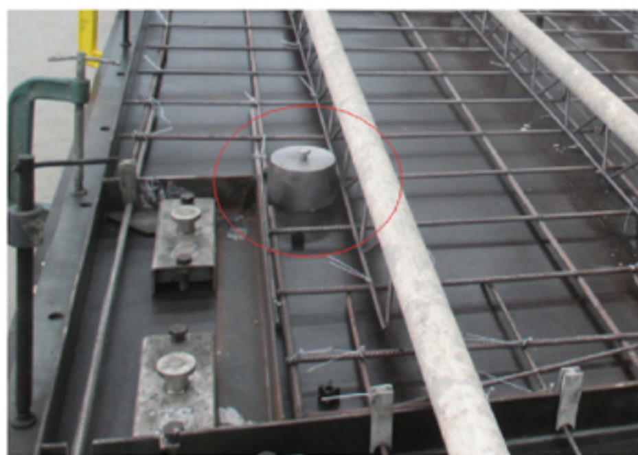
图8 工厂叠合板预留洞磁铁
